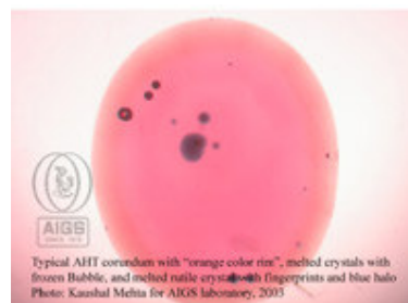
Corindon traité typique avec couleur périphérique orange, cristaux fondus en "bulles figées" et cristal de rutile avec "fingerprint" et halo bleu. Photo. Kaushal Mehta pour les laboratoires AIGS, 2003
