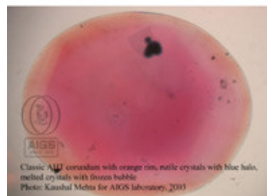
Corindon traité classique avec périphérie orange, cristaux de rutile avec halos, cristaux fondus avec bulles figées bleu. Photo. Kaushal Mehta pour les laboratoires AIGS, 2003
