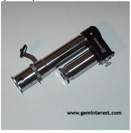
Bien que le spectroscope à main (de poche) soit un des instruments portable les plus difficiles à maîtriser, il peut être aussi un des instruments les plus puissants dans l'arsenal du gemmologiste sur le terrain.
