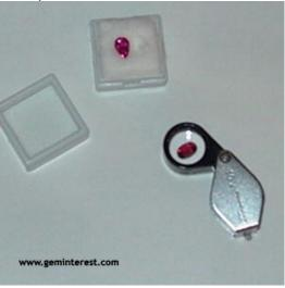
Il y a beaucoup de loupes employées par les gemmologistes. La loupe de poche est la plus couramment utilisée. Une bonne loupe (triplet) qui diminue la distorsion au bord de la surface d'observation équipée d'un système fond noir « darkfield » ou d'un éclairage oblique fournira une meilleure vue sur l'intérieur de la gemme.
