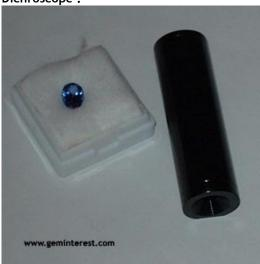
Un des instruments gemmologique facile à transporter et à utiliser et informatif est le dichroscope.
