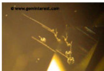
Img1 : Bulles déformées avec une « queue » en inclusion dans un oxyde de zirconium synthétique vert-brun - 1.50ct.
